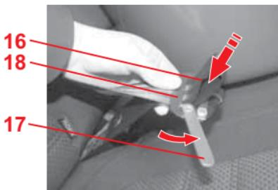
☞ Greifen Sie den Autogurt-Beschlag **18** mit beiden Händen und drehen Sie ihn nach vorne um den Autogurt zu lockern.
