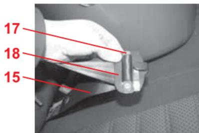
⇨ Поверните красный фиксатор **17** на пряжке автомобильного ремня **18** в сторону.
