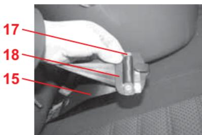
Desplace a un lado el cierre rojo **17** de la hebilla del cinturón de seguridad **18**.
