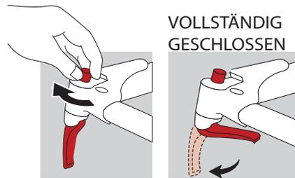
Um die Schnellkupplung richtig zu schließen und das Hinterrad in den Ausfallenden zu sichern, sichergehen, dass die Achse vollständig im Ausfallende sitzt, dabei das Rad in seiner Position halten und die Schnellkupplung Richtung Kinderwagen in die VOLLSTÄNDIG GESCHLOSSENE Position drehen.
